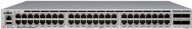
図2: ExtremeSwitching VDX 6740Tスイッチは、48個の1000BASE-T/10GBASE-Tポートと4個の40 GbE QSFP+ポートを備えています。
