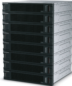
Lenovo Storage S3200 コントローラ・ユニットは、7 つの E1024 拡張ユニットで最大で合計 192 のドライブを提供します。
